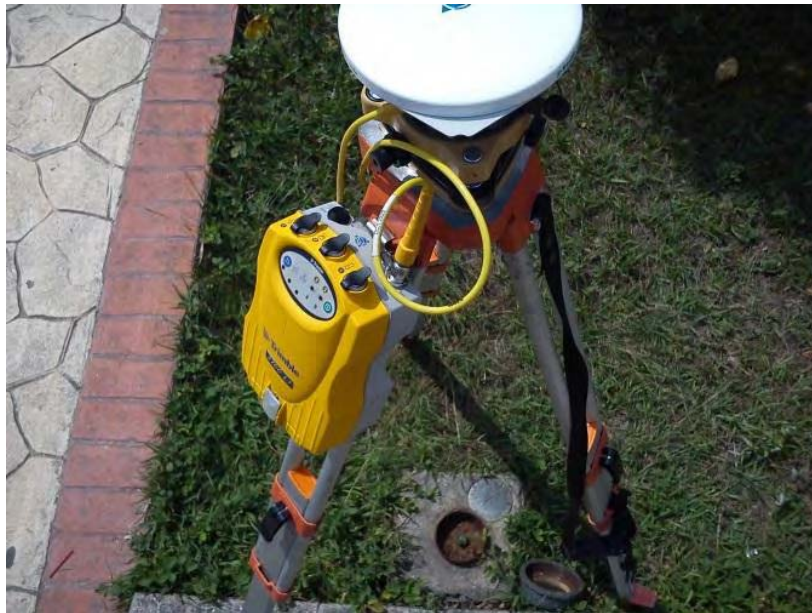
Figura N°18: Mediciones en el Control Geodésico La Cejita
