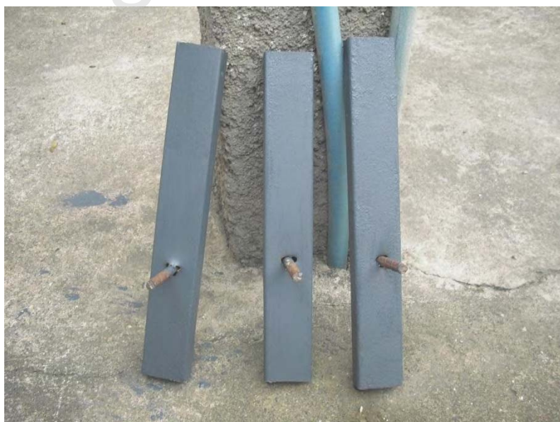
Figura N°32: Refuerzo Metálico de los Vértices de Densificación
