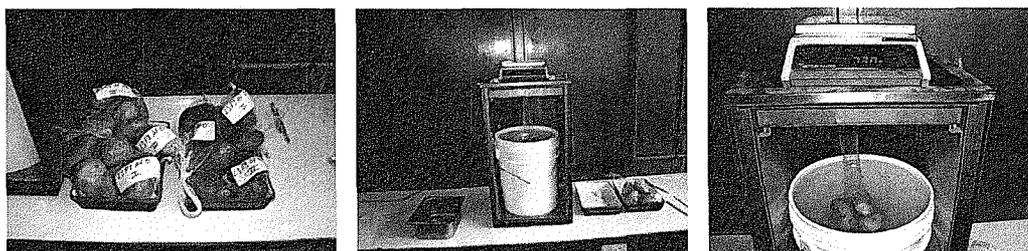
**Figura 4.10** Determinación de la gravedad específica en tubérculos comerciales de Andinita.
