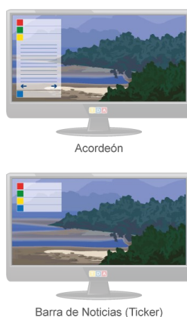
Figura 19. Opciones de ubicación de la aplicación interactiva cuando se posiciona sobre la señal del televisor (Elaboración propia, basada en CNTI (2013)).
