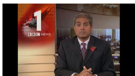
Efecto "Bandas negras a los costados" Contenido 4:3 mostrado en 16:9
