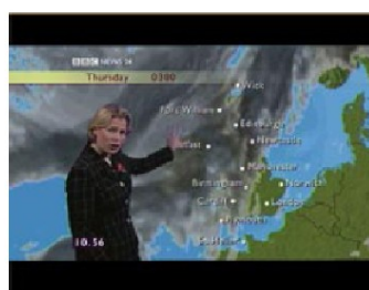
Efecto "Bandas negras arriba y abajo" Contenido 16:9 mostrado en 4:3
