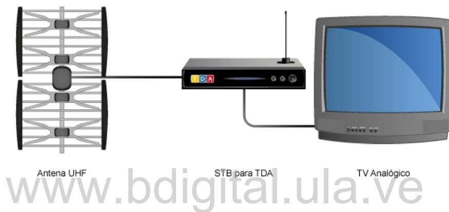
Figura 4. Conexión de televisor analógico a equipo decodificador (Elaboración propia).
