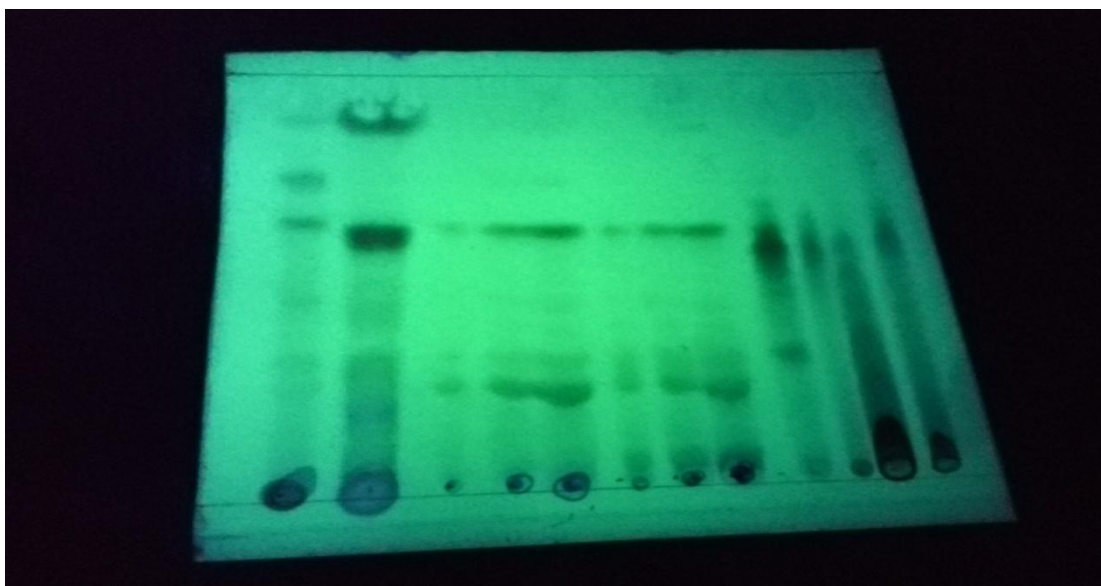
Fig34. Cromatografía N°2 en Luz UV onda larga.
