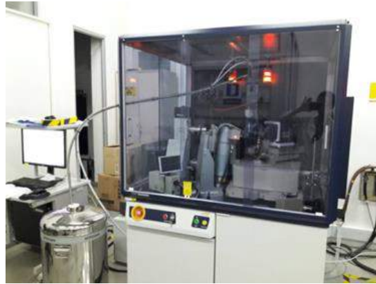
Figura 27. Difractómetro de Monocristal RigakuXtaLAB Pro con detector PILATUS 200K de la Universidad Industrial de Santander (UIS), Bucaramanga, Colombia.
