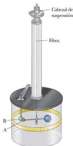
Figura 0.2 Balanza de torsión de Coulomb, utilizada para determinar la ley del cuadrado inverso para una fuerza eléctrica entre dos cargas [3]
