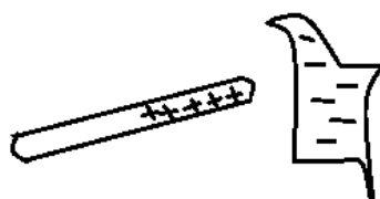
Figura 2.9 electrificación por fricción [7]
