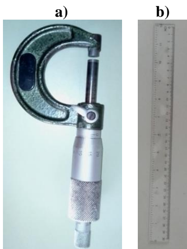
Figura 3.5. Instrumentos de medida a) tornillo micrométrico y b) regla.
