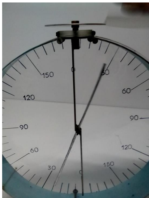
Figura 3.3 Detección de la carga en el electroscopio de los materiales cuero y acrílico
