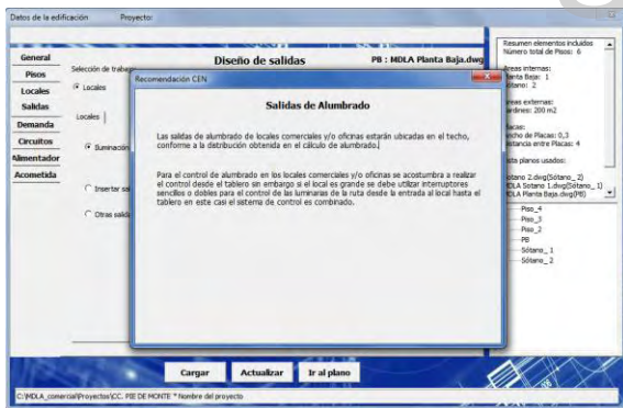
Figura N° 4.21 CEN Salidas de alumbrado. Fuente: Autor
