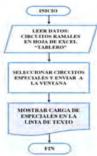
Figura 3.69 Diagrama de flujo Carga conectada Fuente: Autor
