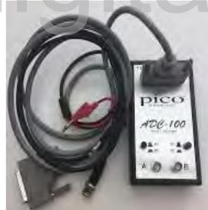
Figura 3.32. Tarjeta de adquisición de datos Pico Technology DAC-100.
