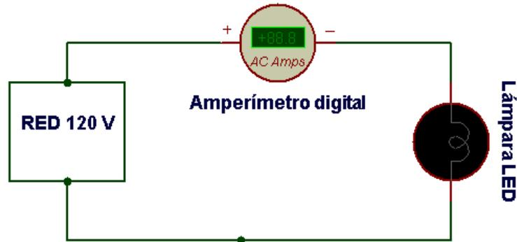
Figura 3.25. Circuito de medición para la corriente de las lámparas LED
