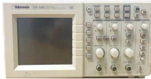
**Figura 3.3. Osciloscopio TEKTRONIX TDS1002.**
