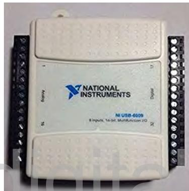
Figura 3.49. Tarjeta de adquisición de datos National Instruments 6009.
