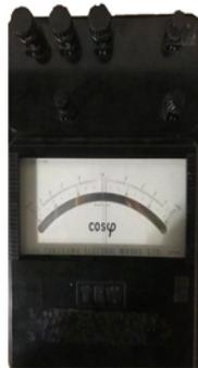
Figura 3.28. Cosfímetro para medir el factor de potencia.
