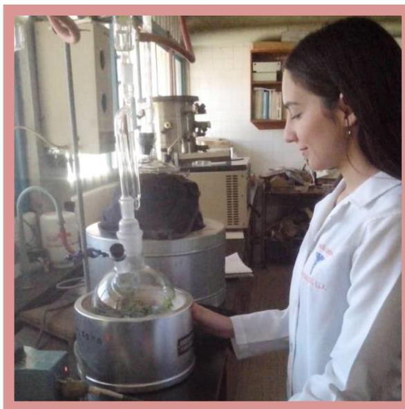
**Figura 16.** Hidrodestilación simple empleando trampa de Clevenger. **Fuente.** Elaboración propia. Luisi y Quintero (2019).
