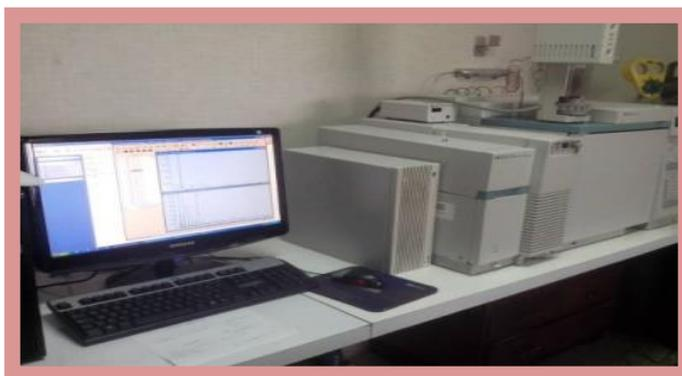
**Figura 17.** Cromatografía de Gases acoplada a Espectrometría de Masas.
