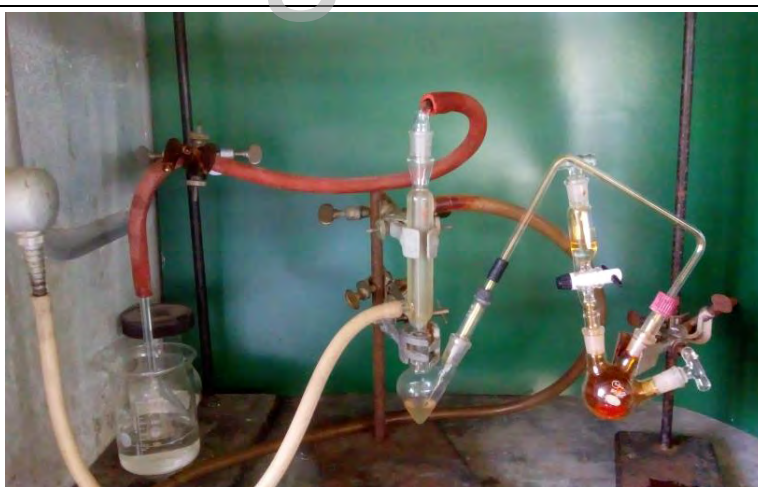
Figura 17. Equipo para la síntesis de hidrácidos de \beta -pineno.
