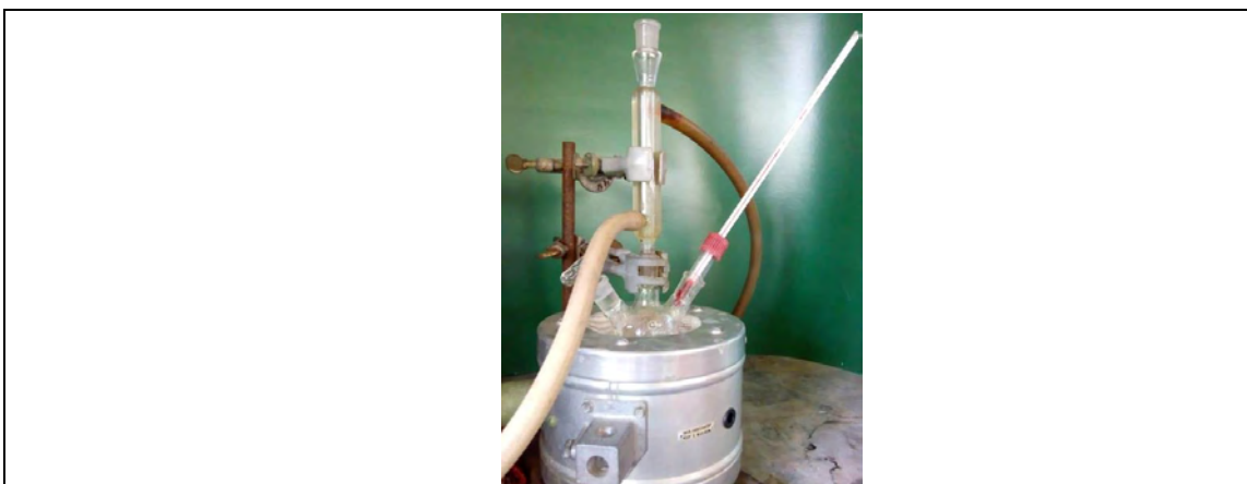
Figura 33. Equipo empleado en la reacción de hidratación de \beta -pineno.
