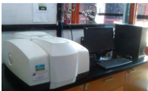
Figura 21. Espectrofotómetro de Infrarrojo con transformada de Fourier, Marca Perkin Elmer, Modelo Frontier, perteneciente al Laboratorio de Cinética y Catálisis de la Facultad de Ciencias de la Universidad de Los Andes.
