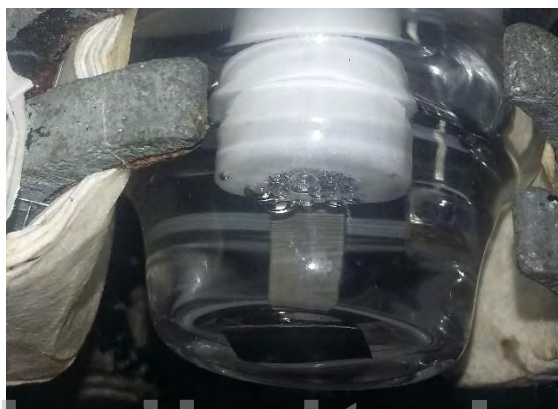
Figura 53. Evolución de hidrógeno sobre la superficie electródica de Ticp como resultado de alcanzar potenciales catódicos.
