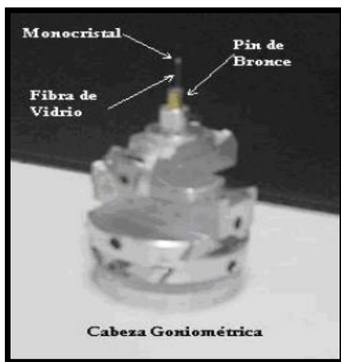
Figura II. 14. Montaje del cristal en la cabeza goniométrica del difractor.
