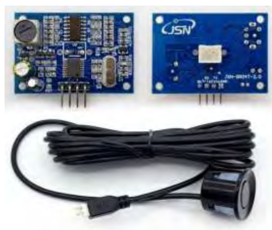
Figura 4.8: Módulo medidor por ultrasonido JSN-SR04. [36]
