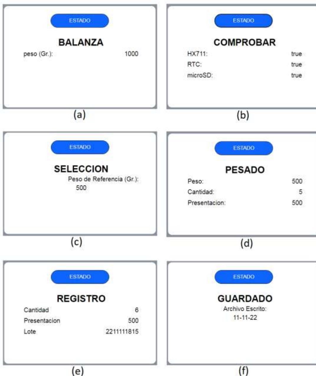
Figura 5.9 (a) Estado de BALANZA, (b) Estado COMPROBAR, (c) Estado SELECCIÓN, (d) Estado de PESADO, (e) Estado de REGISTRO y (f) Estado de GUARDADO.
