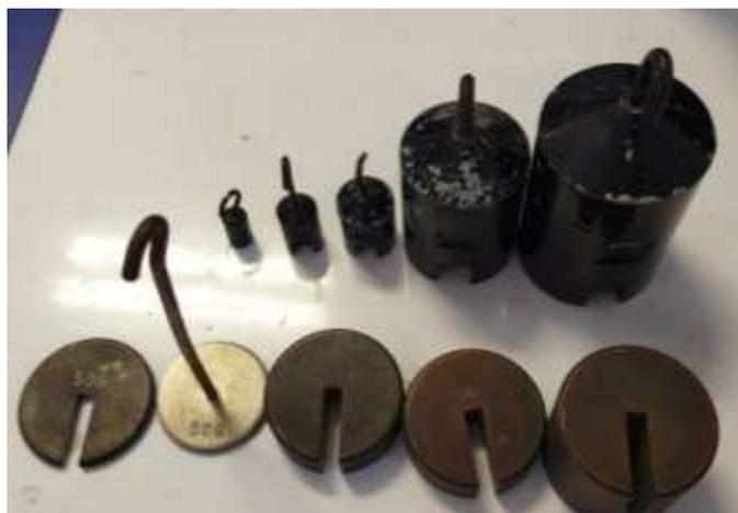
*Figura 5.1 Pesos de calibración.*
