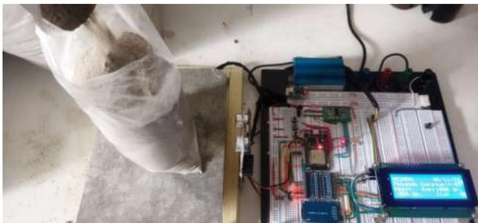
Figura 5.6 Proceso de pesado para empaques de 1000 gr.
