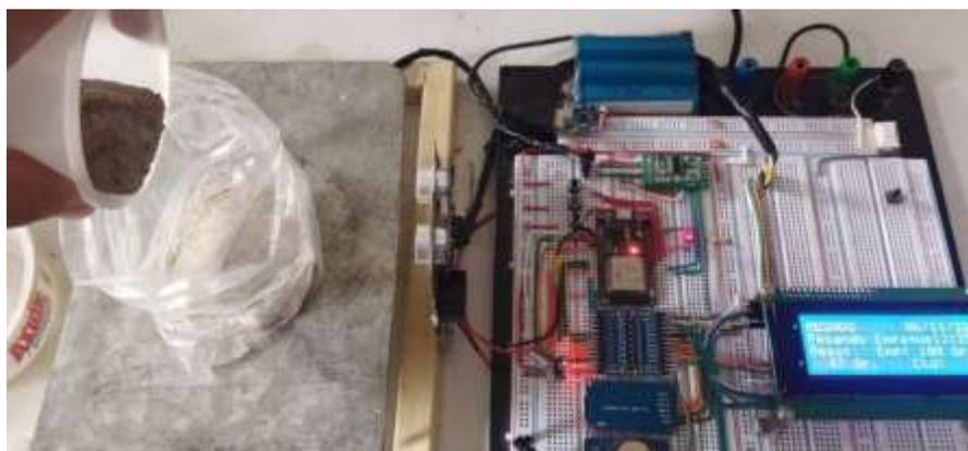
*Figura 5.3 Proceso de pesado para empaques de 100 gr.*
