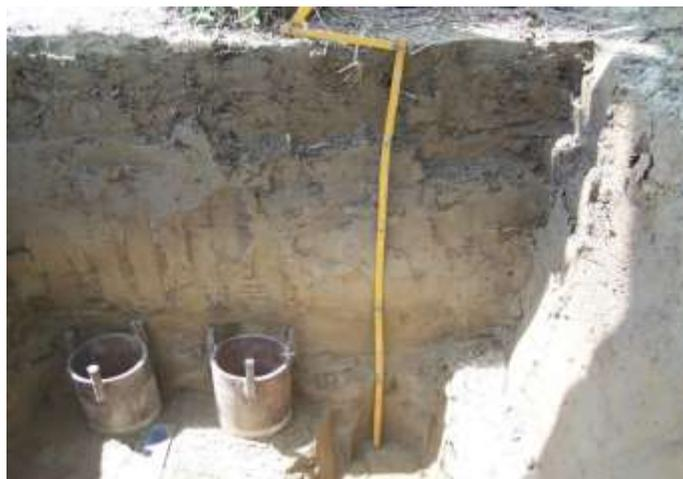
Figura II-6. Perfil del suelo en la calicata realizada para el estudio exploratorio previo a la instalación del ensayo.
