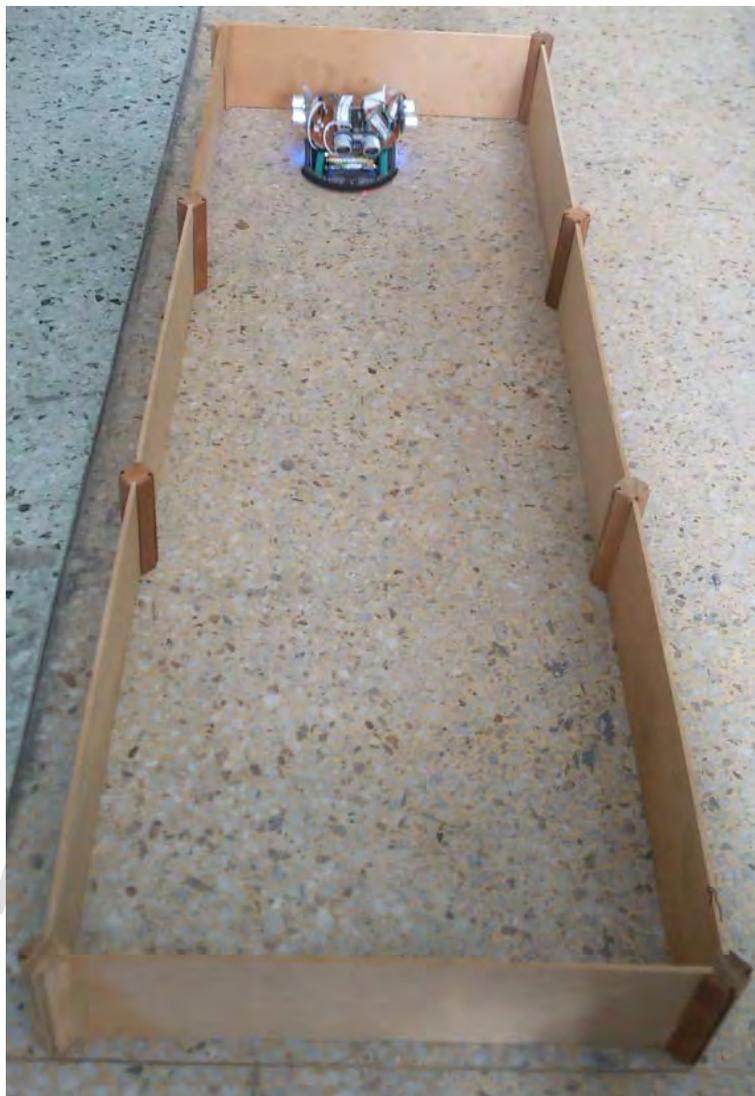
**Figura 3.11 Tramo recto utilizado en la calibración del controlador PID.**
