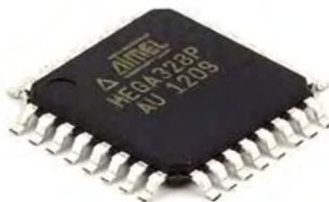
**Figura 2.5** Microcontrolador Atmega328P [4]
