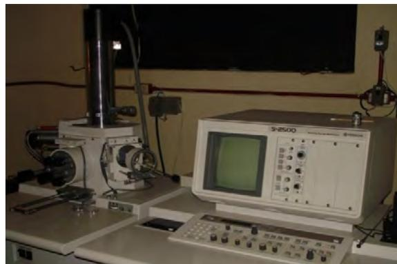
**Figura V. 11:** Microscopio de Barrido Electrónico
