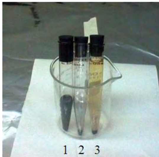
Figura 33. Purificación del óxido de hierro y níquel obtenido
