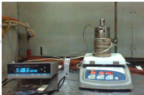
Figura 35. Montaje experimental para tratamiento hidrotérmico
