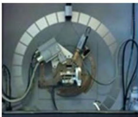
Figura 41. Difractómetro de Polvo (PANalytical-U.Montpellier)
