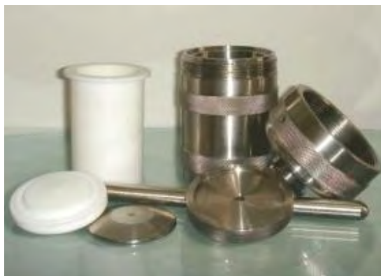
Figura 34. Reactor (KH-100) para síntesis hidrotérmica
