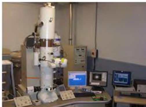
Figura 39. Microscopio Electrónico de Transmisión (JEOL JEM 2100 PDVSA-Intevep)
