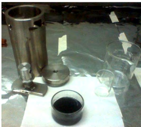
Figura 36 . Apariencia final de la mezcla sometida a tratamiento hidrotérmico
