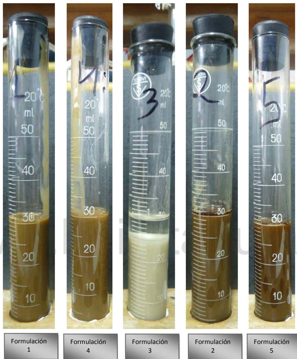
**Fig. 41.** Suspensiones de bentonita a las 24 horas.
