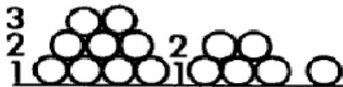
**Figura I.1.2** Adsorción física (multicapas), (Farrauto, 1997).
