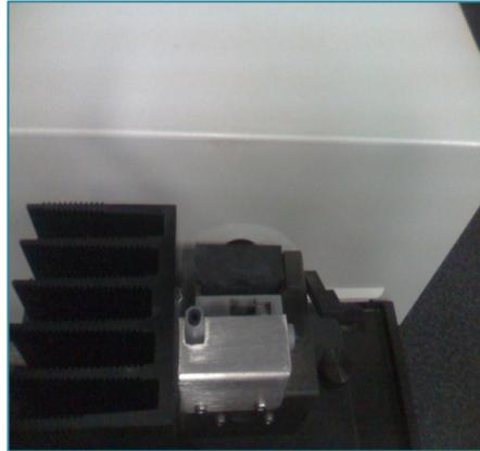
Figura 24. Celda empleada para medir el tamaño de gota en el espectrofotómetro.
