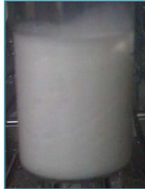
**Figura 33. Emulsión obtenida al aplicar el método de emulsión por la temperatura de inversión de fases PIT.**
