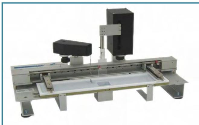
Figura 9. Esquema de la bandeja de Langmuir. [9]
