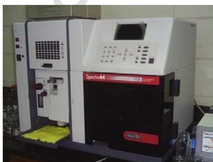
**Figura 9.2 Equipo de espectroscopía de llama**
