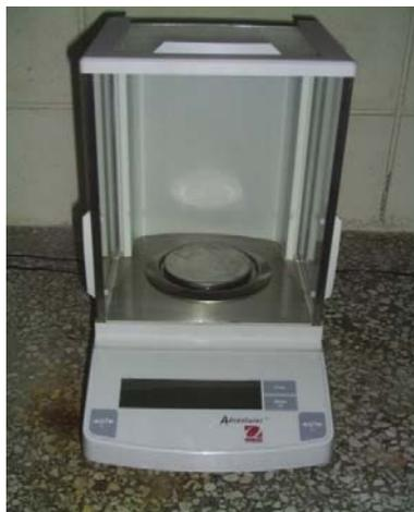
**Figura 9.1 Balanza analítica usada**
