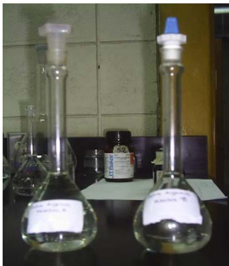
**Figura 10.1 Muestras obtenidas luego de la digestión acida para bentonita purificada (izquierda) y no purificada (derecha).**
