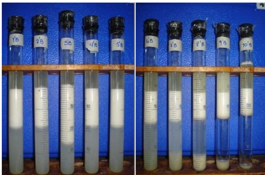
**Figura 10.10. Separación de fases al equilibrio para el sistema aceite de soya – agua – bentonita purificada.**
