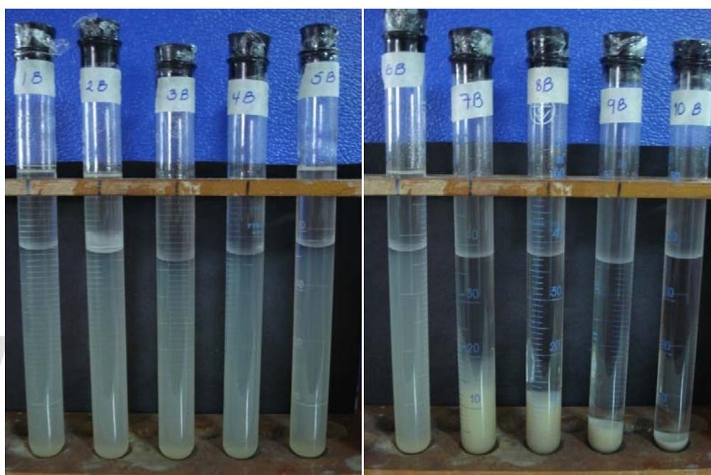
**Figura 10.5. Separación de fases al equilibrio para el sistema parafina – agua – bentonita purificada.**
