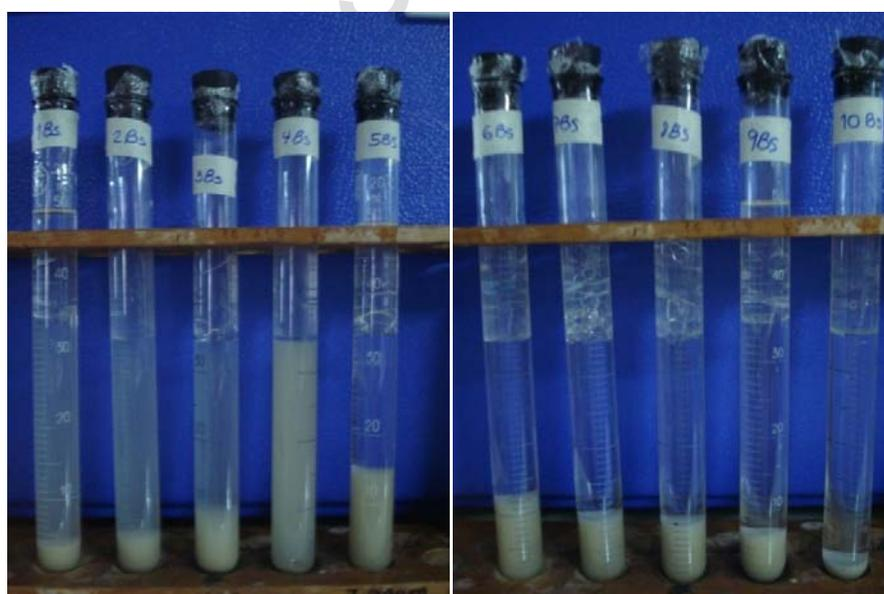
**Figura 10.7. Separación de fases al equilibrio para el sistema parafina – agua – bentonita natural.**
