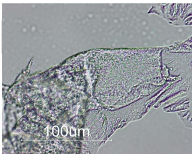
**Figura 10.11. Observación al microscopio de la estructura estabilizadora formada en los sistemas aceite de soya – agua – bentonita natural**
