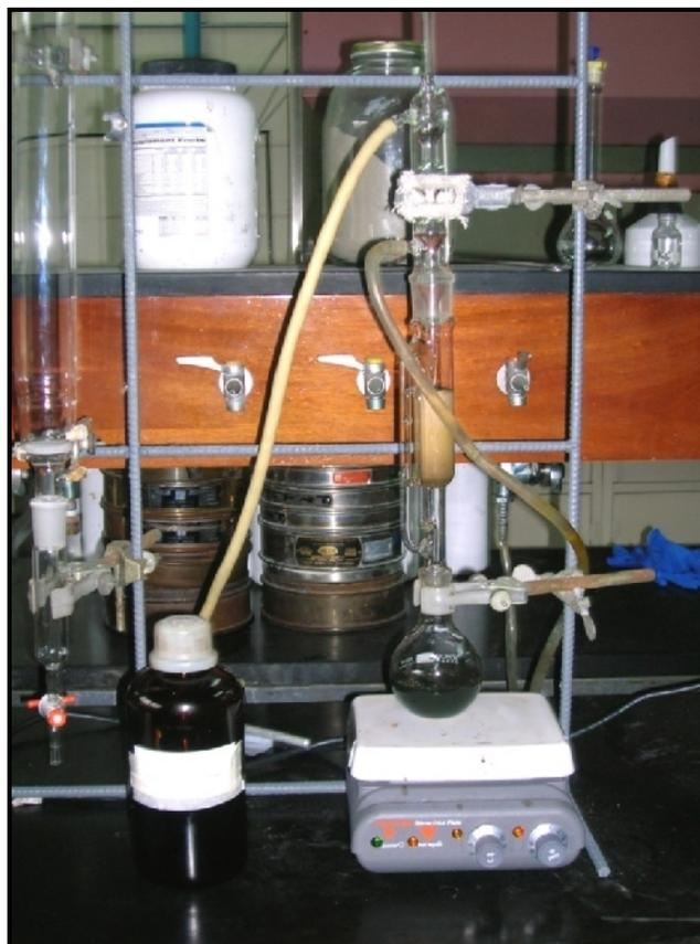
**Figura 17. Equipo Soxhlet llevado a cabo para la extracción del asfaltenos del crudo Ayacucho.**
