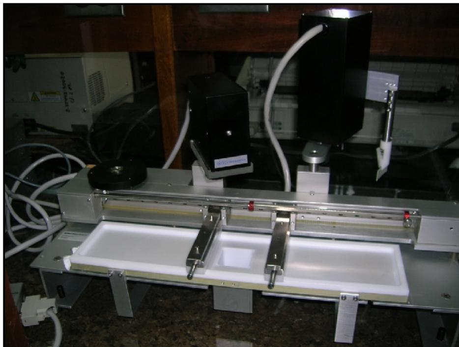
Figura 15. Fotografía de la bandeja de Langmuir usada en los experimentos.
