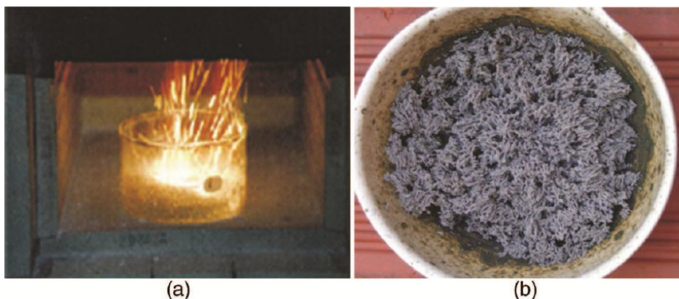
Figura 6. Reacción autosostenida para la síntesis de combustión en solución de un óxido tipo perovskita. (a) Inicio de la combustión (b) Producto final.
