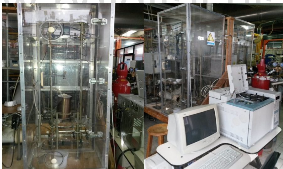
Figura 11. Sistema de reacción para las pruebas catalíticas RSM junto con el CGases marca HP modelo 6890 plus, ubicados en el Laboratorio de Cinética y Catálisis, Facultad de Ciencias de la Universidad de Los Andes.
