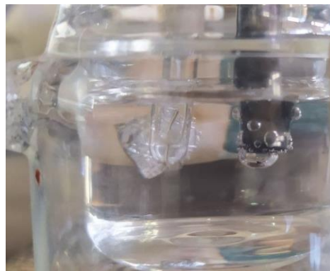
Imagen 5.4. Detalle fotográfico de la celda electroquímica durante la realización de una curva de polarización en \text{KOH} .
