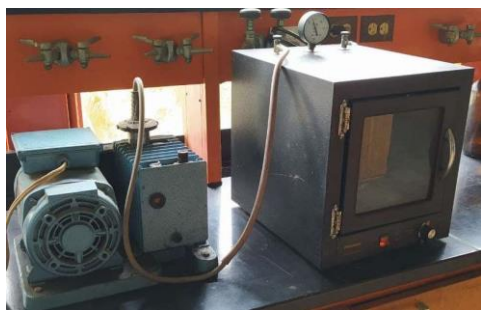
Imagen 2.4. Detalle fotográfico del horno de vacío Precision Scientific Vacuum Oven Model 19
