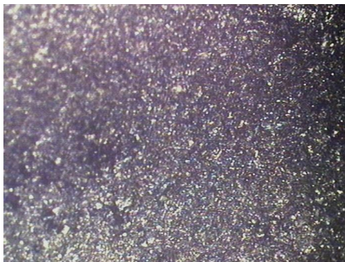
Imagen 3.1. Detalle fotográfico de la superficie de un EPC pulido, previo a realizar cualquier estudio electroquímico.
