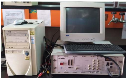
Imagen 2.2 Detalle fotográfico del potenciostato AUTOLAB modelo PGSTAT20
