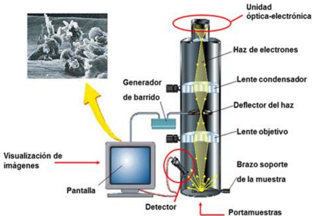
**Figura 3.1.** Componentes fundamentales de un Microscopio Electrónico de Barrido [37]
