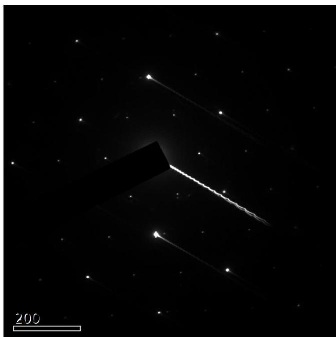
Figura 4.10. Patrón de difracción del Ag<sub>2</sub>SnSe<sub>3</sub>.
