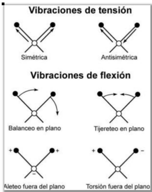
Figura II.1. Modos de vibración molecular.
