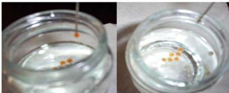
**Fig. 9:** Elaboración de los hidrogeles en forma de esferas a partir de las mezclas de caseína/genipina estudiadas.
