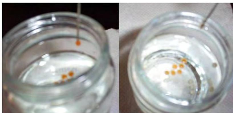
Fig. 18: Formación de esferas dejando caer las gotas de la mezcla de caseína/genipina en HCl concentrado.
