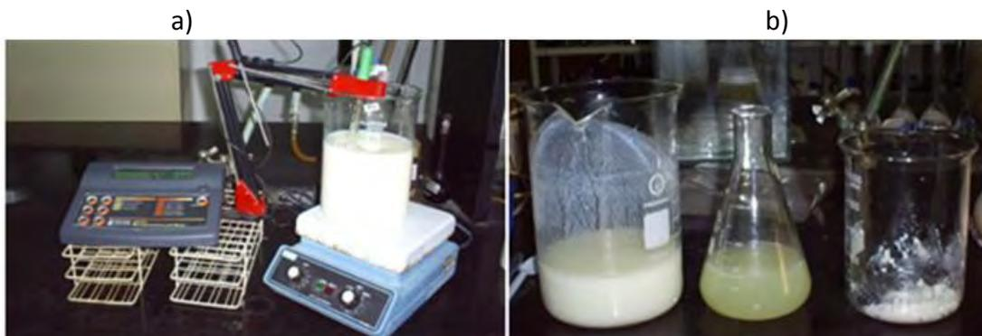
Fig. 6: a) Sistema utilizado para la extracción de la caseína. b) Eliminación del sobrenadante, luego de la precipitación.
