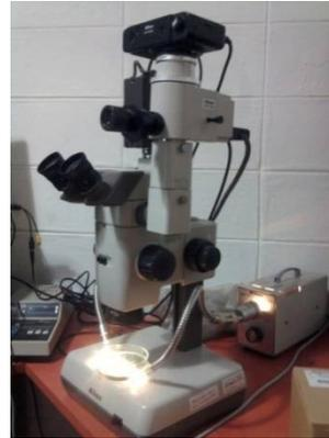
**Figura 2.** Microscopio de luz polarizada.
