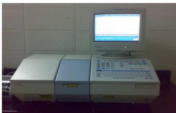
**Figura 20.** Espectrofotómetro Infrarrojo (*FT-IR*) *Perkin Elmer RX1* del Laboratorio de Docencia en Química Orgánica (ULA)
