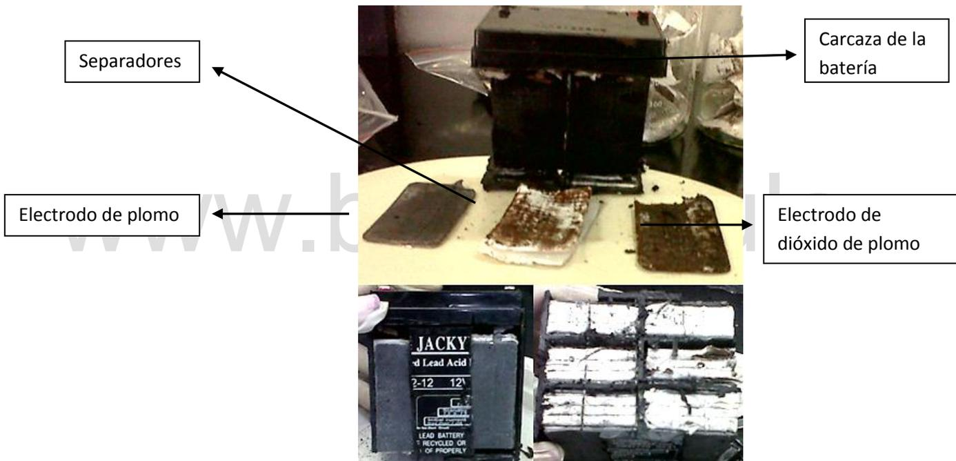
**Figura 19.** Desensamblaje de las baterías de plomo-ácido.
