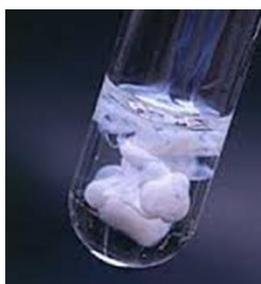
**Figura 59.** Formación de precipitado de cloruro de plomo ( $PbCl_2$ ) mediante prueba por vía húmeda.
