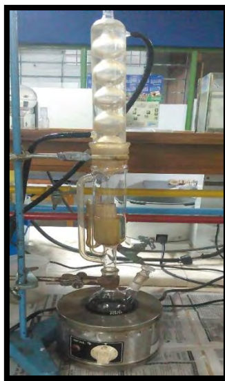
Figura 28. Equipo SOXHLET para el lavado de los asfaltenos.
