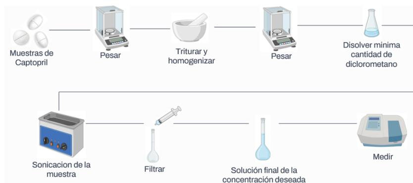
Figura 17. Esquema de la preparación y tratamiento de la muestra.
