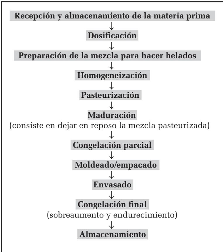
**Figura 9.4** Fabricación de helados
