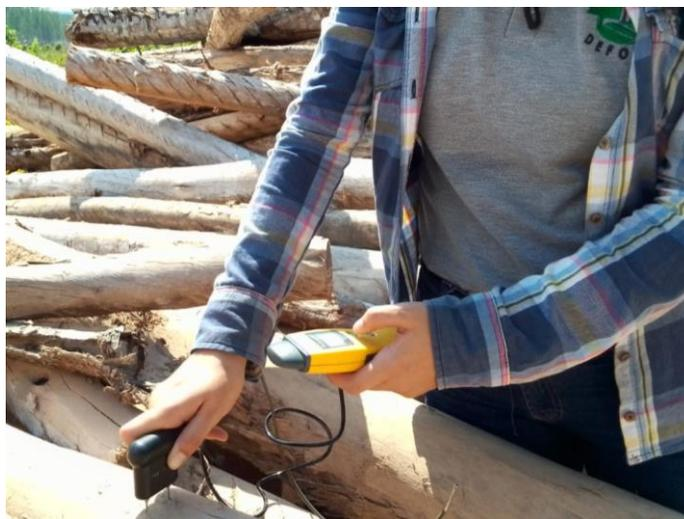
**Figura 5.** *Medición del contenido de humedad de la madera*
