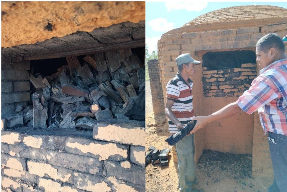
**Figura 10.** *Apertura del horno y descarga del carbón.*
