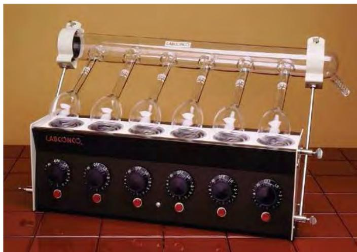
**Figura 16.** Equipo de digestión de micro Kjeldahl del Laboratorio de Raíces y Cereales de La Universidad Central de Venezuela.
