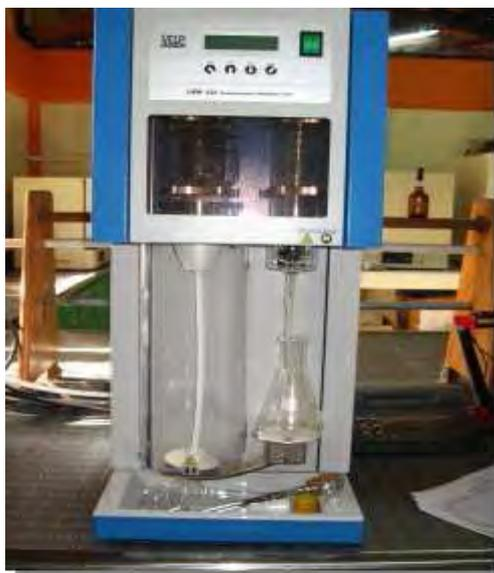
**Figura 15.** Equipo de destilación de micro Kjeldahl del Laboratorio de Raíces y Cereales de La Universidad Central de Venezuela.
