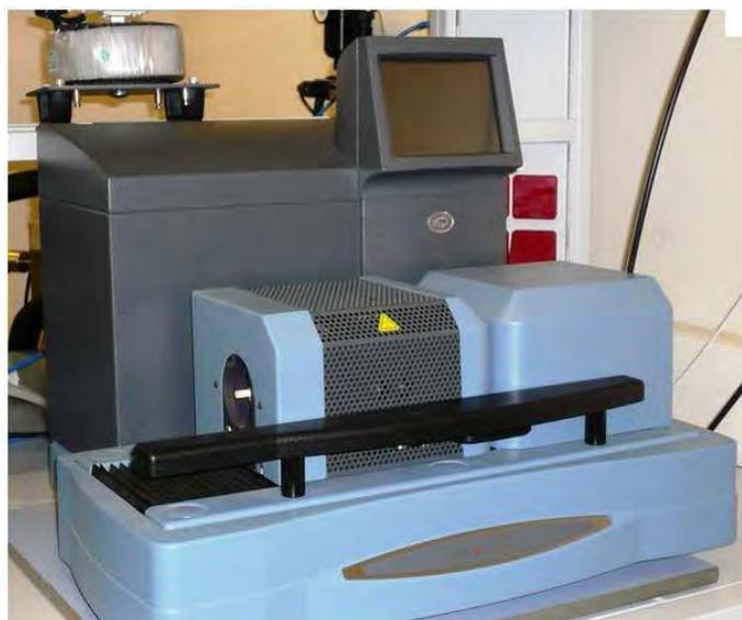
**Figura 20.** Analizador térmico marca TA Instruments, modelo SDT Q600, perteneciente al Laboratorio de Cinética y Catálisis de La Facultad de Ciencias de La Universidad de Los Andes.
