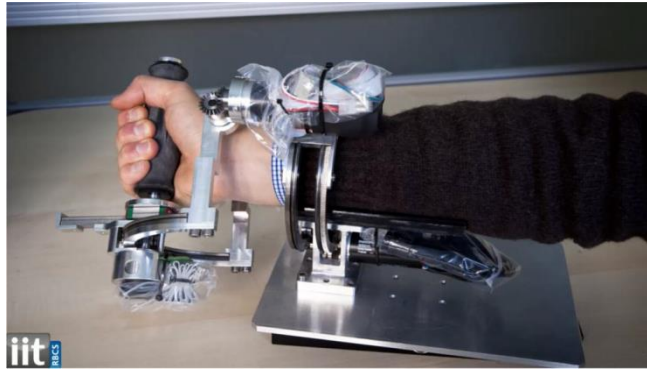
Figura 5. Robot de Rehabilitación para pacientes con lesiones crónicas. (Tomado de Squeri et al., 2013)
