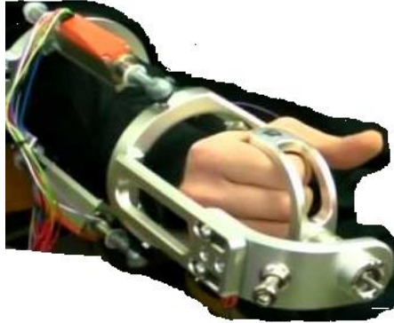
Figura 7. Robot Terapéutico para muñeca, (Tomado de Masia, L. et al, 2007).
