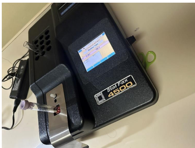
Figura 3. Espectrofotómetro Stat Fax para realizar análisis de glucosa en sangre.
