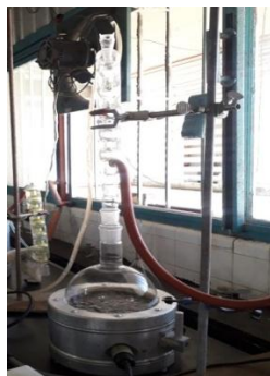
Figura 12. Equipo de extracción por reflujo
