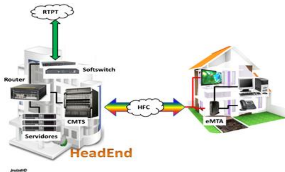
Ilustración 14: Arquitectura Básica de PacketCable®. Fuente: Jesús Ruíz Díaz, 2016.
