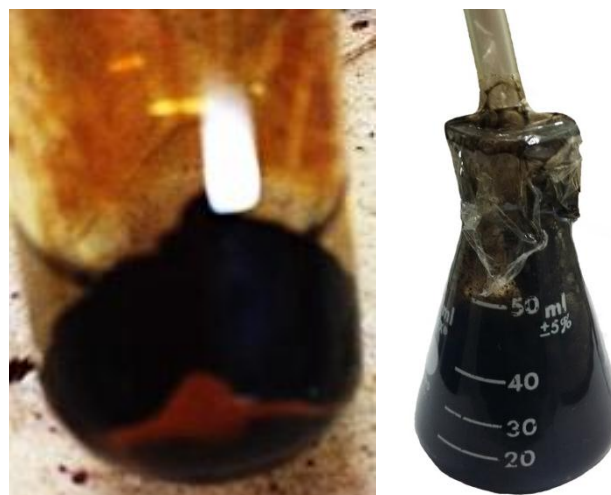
Fig. 1. Productos obtenidos en la síntesis del compuesto \text{Fe}_3\text{O}_4 -I (izquierda) y del compuesto \text{Fe}_3\text{O}_4 -II (derecha).
