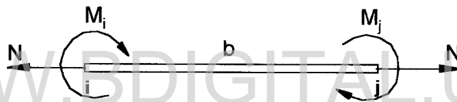
Figura 6.6. Esfuerzos generalizados en un miembro en un pórtico plano.
