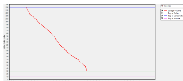
Figura 7: Volúmenes Almacenados operando solo Lagunillas
