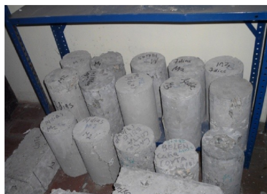
Figura 9: Concreto reforzado con fibras experimentando buena tenacidad.
