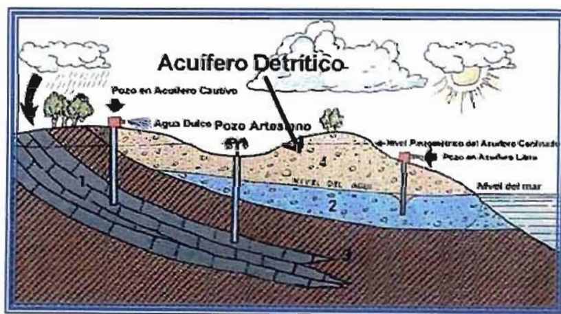
Figura II-20. Representación esquemática de un Acuífero Detrítico. Tomado de: http://www.fortunecity.com/.../195/hidro/detriti.htm
