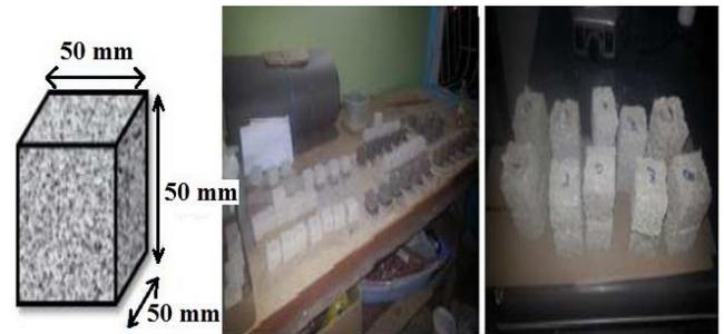
**Figura 1. Probetas preparadas para el análisis de las mezclas poliméricas propuestas**
