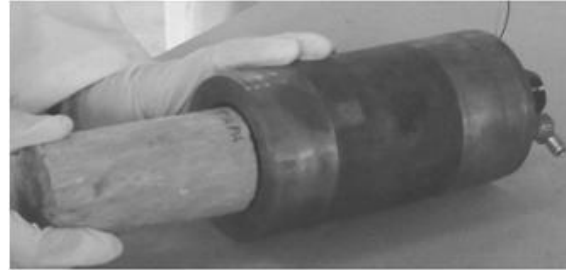
Fig 1. Cámara de combustión para combustible sólido basada en cohete sonda ULA 1A.
