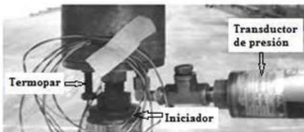
Fig. 4. Transductor de presión, termopar e iniciador dispuestos en la culata del motor. (Lacruz y col., 2015).
