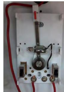
Fig. 10. Termostato gota de Mercurio
