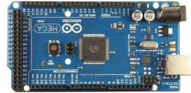
Fig. 3. - Arduino mega 2560
