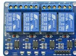
Fig. 4.- Módulo de rele de 4 canales
