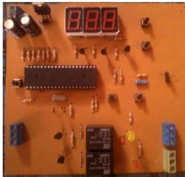
Fig. 20. Tarjeta de monitoreo/actuación para Temperatura.
